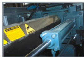
Straight clamping system 直压式开合模系统
