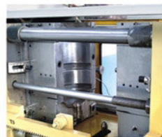
Mold clamping system 开合模机构
